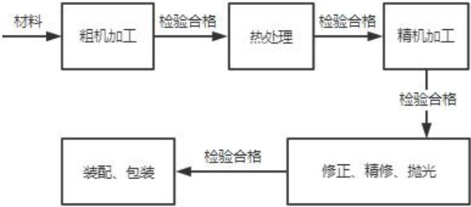
图 3-2 压铸模具生产工艺流程图
